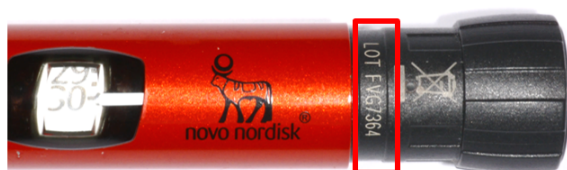
Slika 2. Crveni pravokutnik pokazuje gdje se nalazi broj serije na brizgalici NovoPen® Echo®. Npr. broj serije na brizgalici NovoPen® Echo® je FVG7364.
